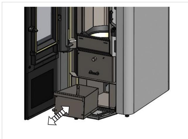
Abb. 21: Aschebehälter entnehmen und leeren
