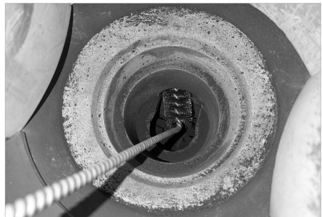
Abb. 27: Brennkammer/Rost reinigen
