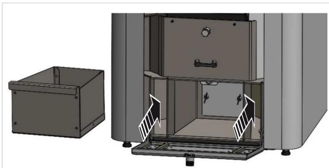
Abb. 13: Seitliche Querzüge reinigen
