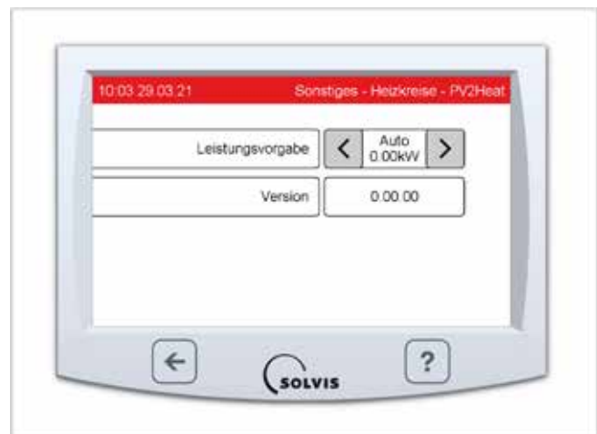
Abb. 24: Automatikbetrieb des Elektroheizstabs
