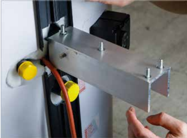
Abb. 8: Kabelführung aus der Isolierung und Halterung des Gestells
