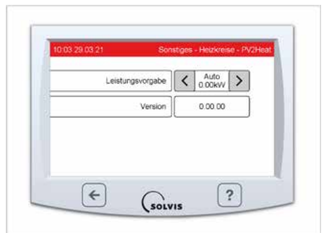
Abb. 25: Automatikbetrieb des Elektroheizstabs
