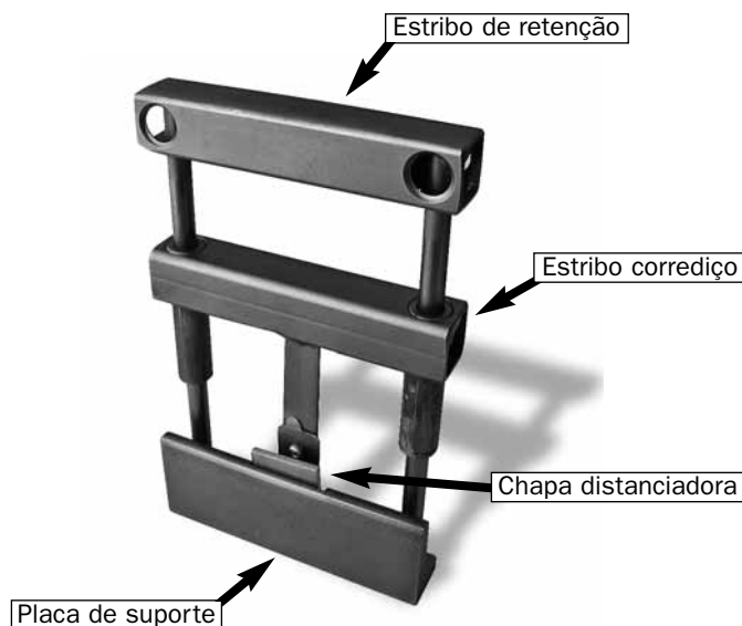
Componentes da peça auxiliar de montagem
