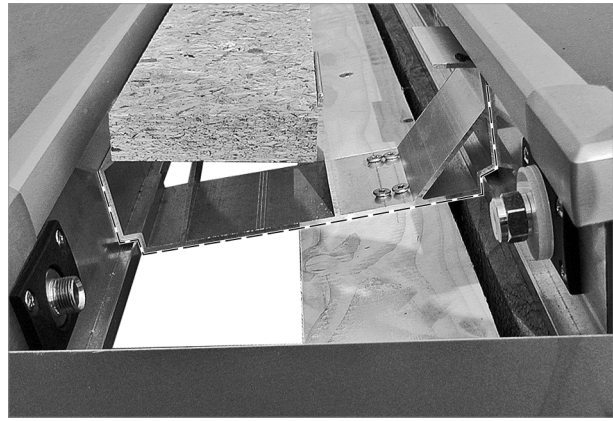
Abb. 62: Sitz der Kollektordistanzstücke an den Kollektoren
