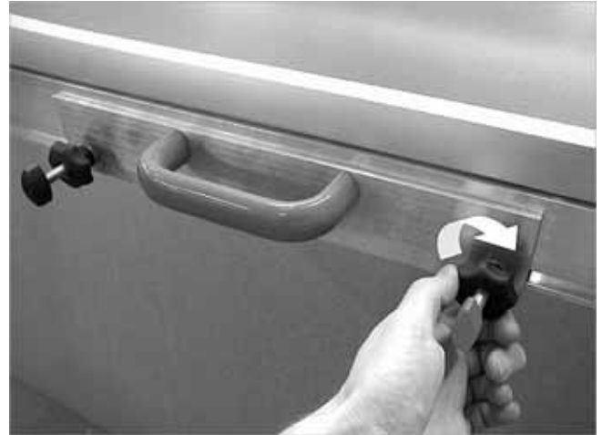
Abb. 5: Festziehen des Kollektorgriffs
