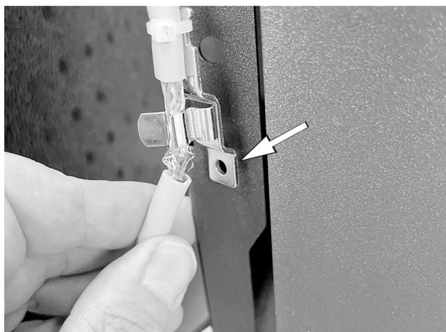
Abb. 8: Schirmklemme an der Netzplatinentür des SolvisBen befestigen
