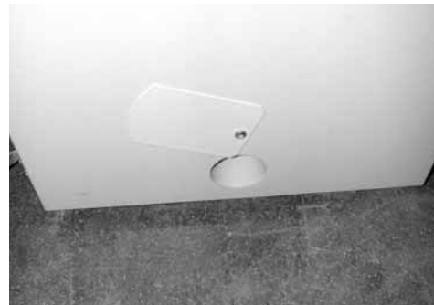
Einfüllöffnung am Ascherollwagen verschließen
