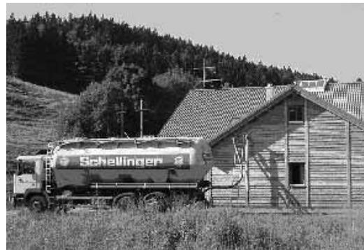
Anlieferung von Pellets im Pelletsilowagen
