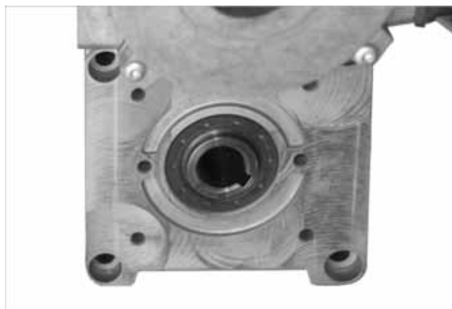
Abb. 7: Dichtring bündig abschließend
