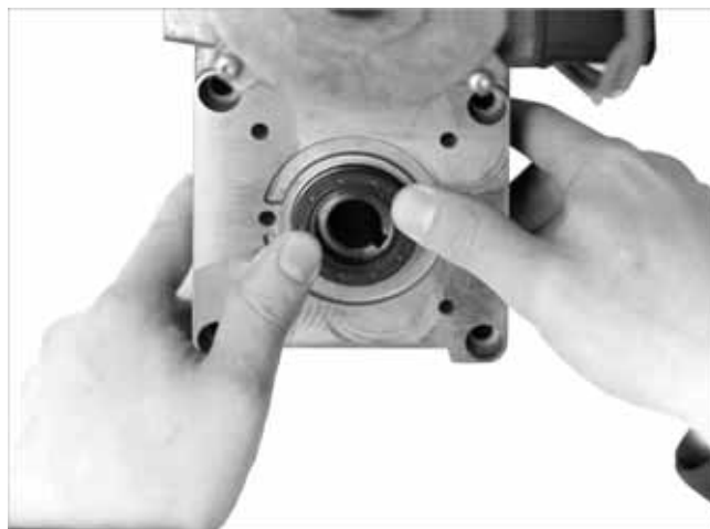
Abb. 6: Dichtring gleichmäßig eindrücken
