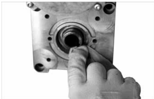
Abb. 3: Lagersitz und Welle säubern / kontrollieren
