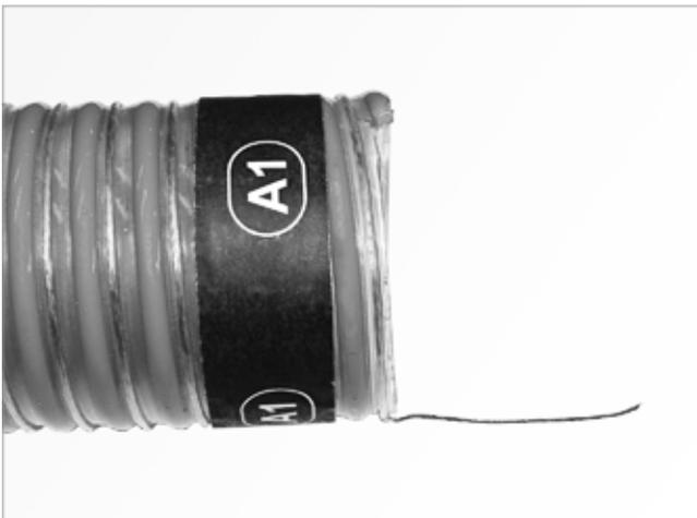
Abb. 59: Erdungsdraht freilegen
