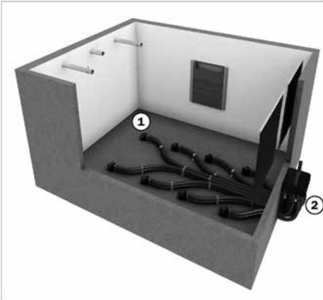
Abb. 8: Pelletlagerraum mit 8-Saugsonden-System
