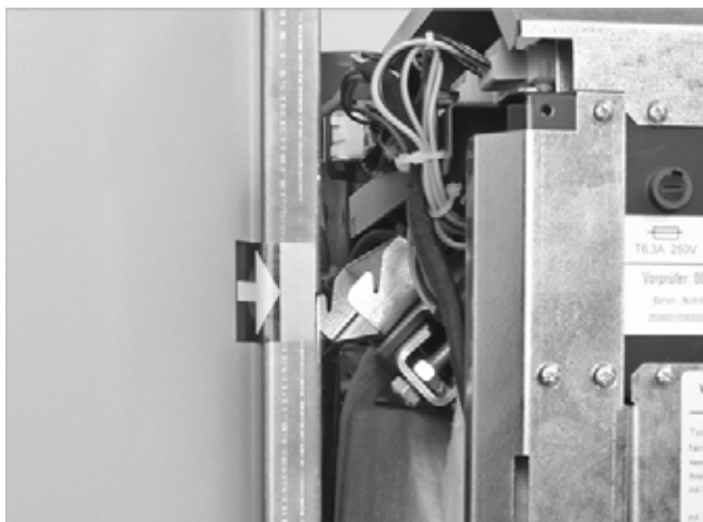
Abb. 29: Vorratsbehälter in beide Haken einhängen
