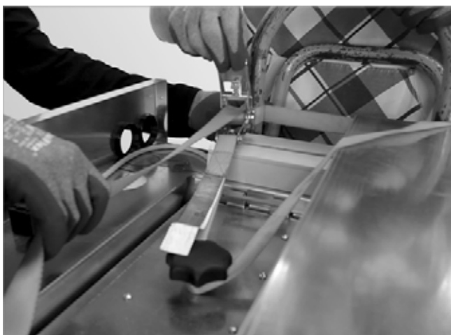
Abb. 10: Kessel an Sackkarre befestigen
