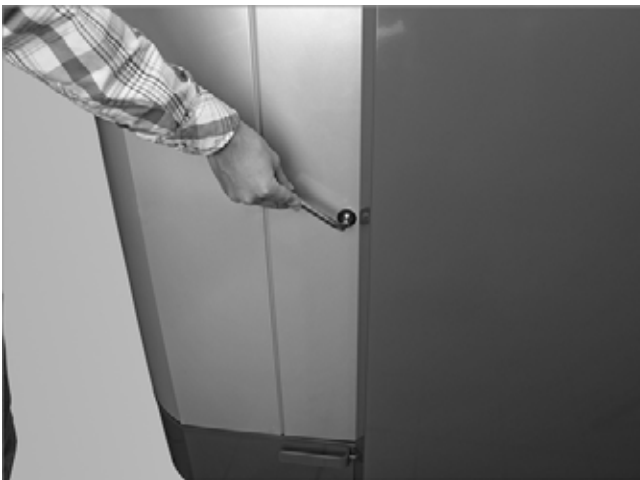
Abb. 125: Mit Sechskantschlüssel Verkleidung öffnen
