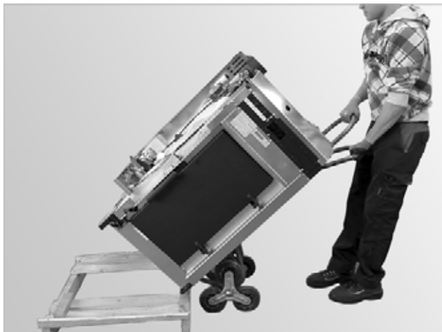
Abb. 11: Kessel von Palette heben
