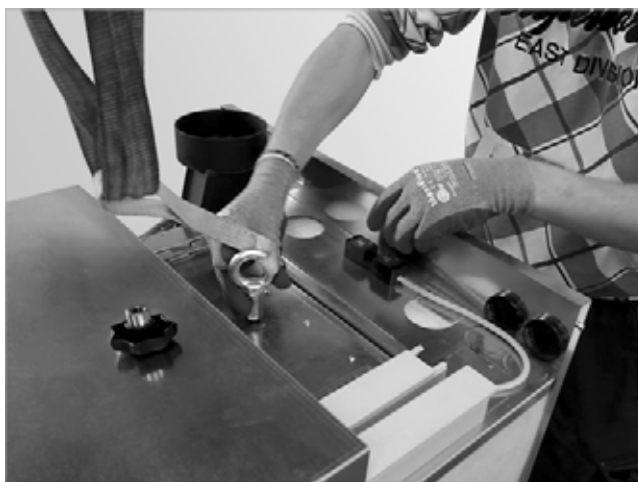
Abb. 12: Öse M12 montieren
