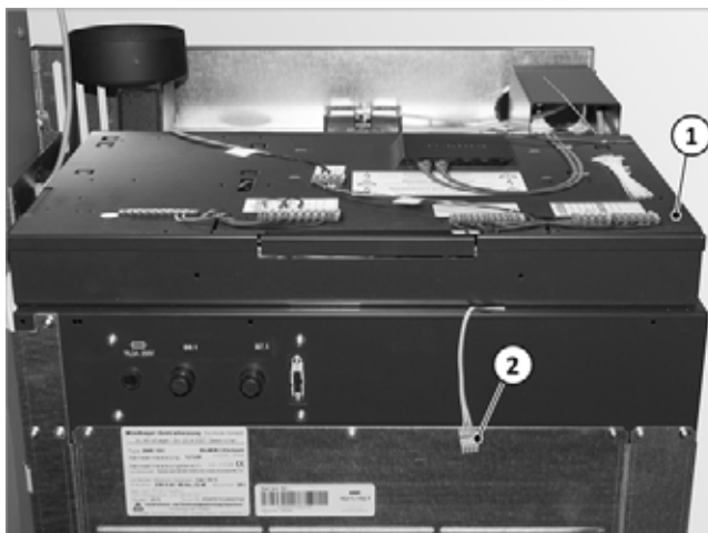
Abb. 69: Deckel vom Schaltfeld aufklappen
