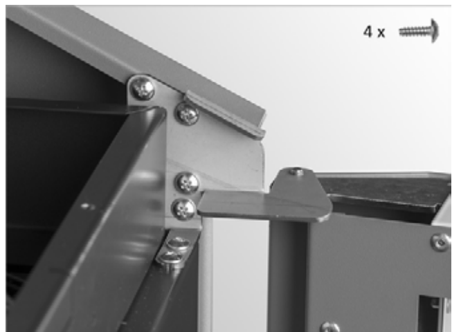
Abb. 89: Türscharnier und Seitenwand festschrauben
