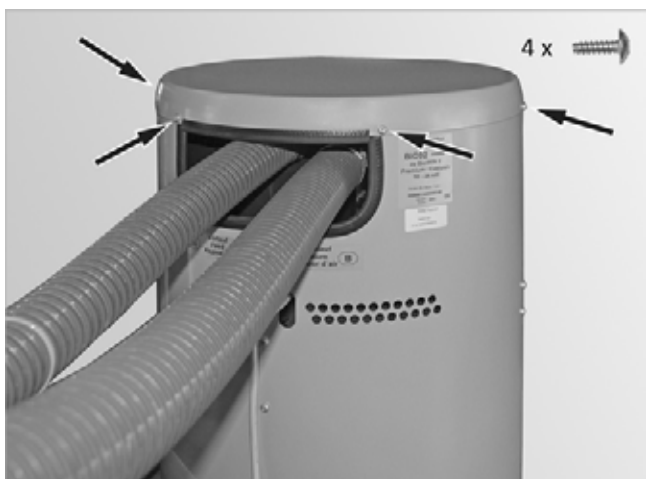
Abb. 105: Montage Förder- und Rückluftschlauch
