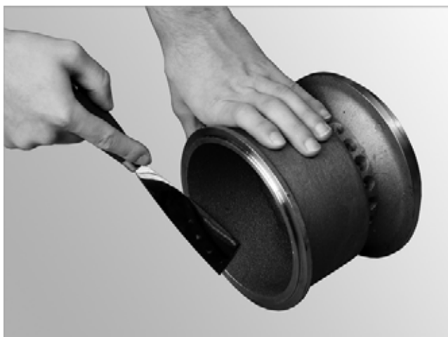
Abb. 147: Konus mit Spachtel reinigen
