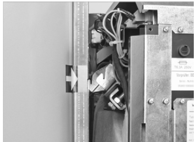
Abb. 57: Vorratsbehälter in beide Haken einhängen
