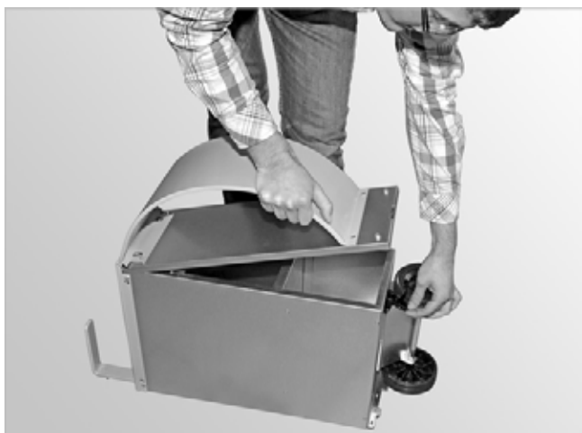
Abb. 137: Deckel des Aschebehälters abnehmen
