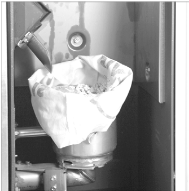
Abb. 122: Auffangbehälter / Sack unter Öffnung halten
