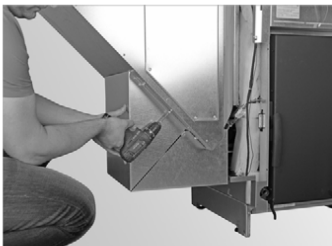
Abb. 60: Sechs Stück Schrauben lockern, Abdeckung abnehmen
