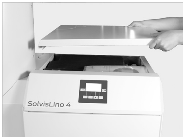
Abb. 129: Verkleidungsdeckel nach hinten abnehmen
