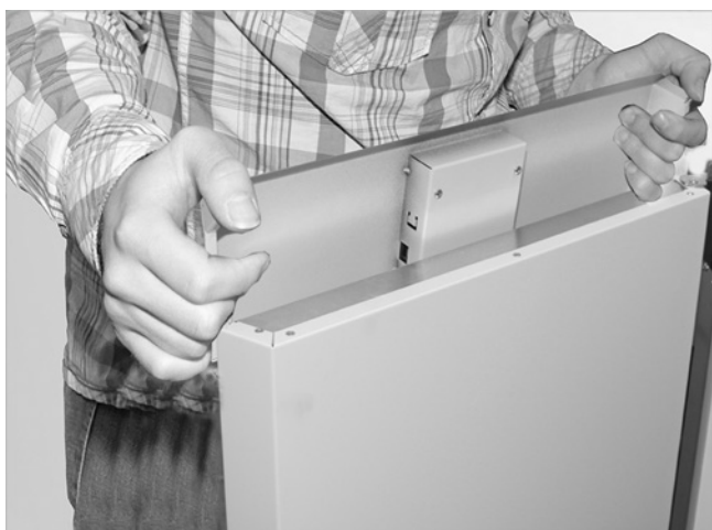
Abb. 112: Schaltblende in Tür einhängen
