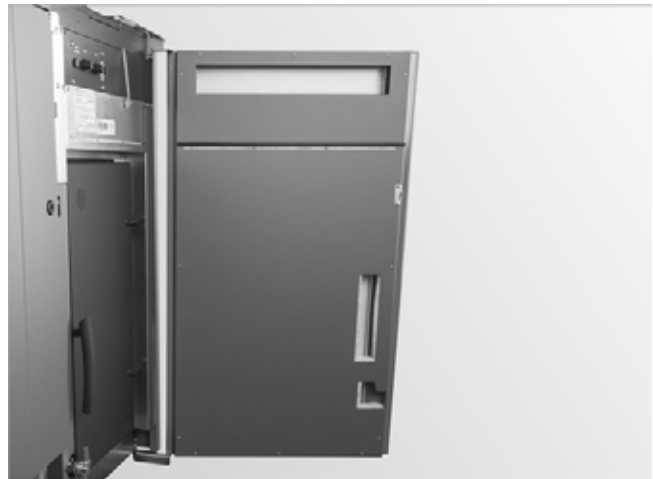
Abb. 88: Verkleidungstür oben und unten einhängen
