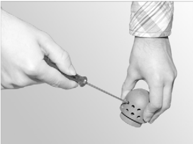
Abb. 150: Primärluftdorn vorsichtig reinigen
