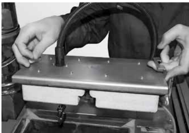
Abb. 161: Deckel herausheben, Kabel belassen
