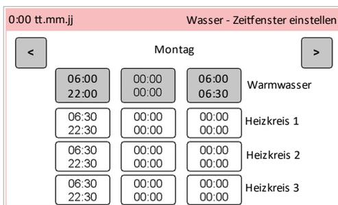
Die Zeitfenster zur Komfortnachheizung auf das Nötige beschränken, da sie zu einem höheren Energiebedarf führen. In der Regel ist das Komfortnachheizen für bestimmte Zeiten in Verbindung mit Wärmepumpen jedoch besser geeignet als die S1-Komfortposition am SolvisBen.
