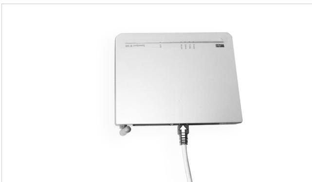
Abb. 12: LAN-Kabel mit Router verbinden
