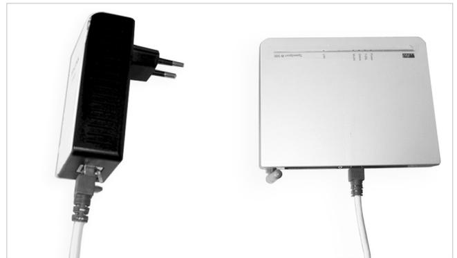
Abb. 14: PowerLine-Adapter mit Router verbinden
